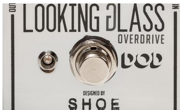
Dank True-Bypass bleibt das Signal bei deaktiviertem Zerrer unbeeinflusst.
