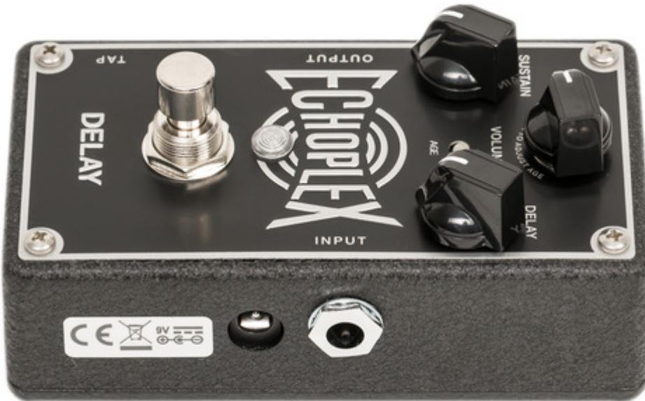
Auf der rechten Seite sind Eingang und Netzteilanschluss untergebracht.
