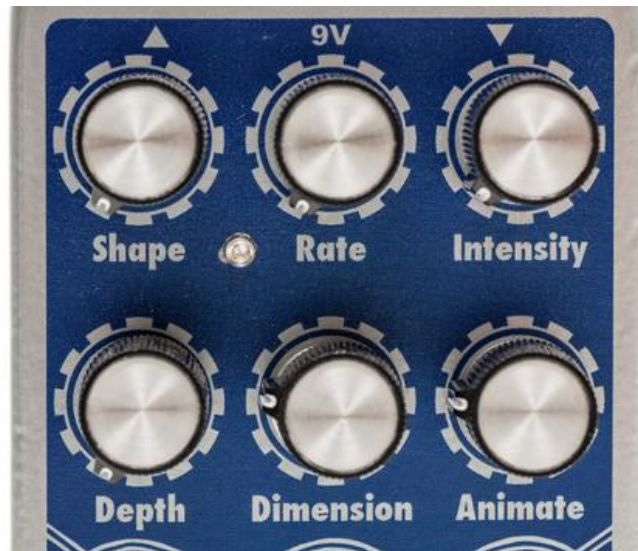
Die Parameter teilen sich in LFO- (obere Reihe) und Delay-Sektion (untere Reihe) auf.
