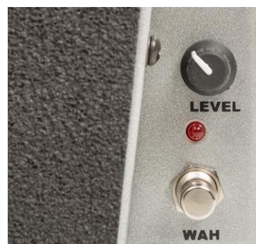
... der Fußtaster zur Aktivierung des Wah-Effekts und ein Regler zur Justierung der Effekt-Lautstärke, warten rechts auf Arbeit
