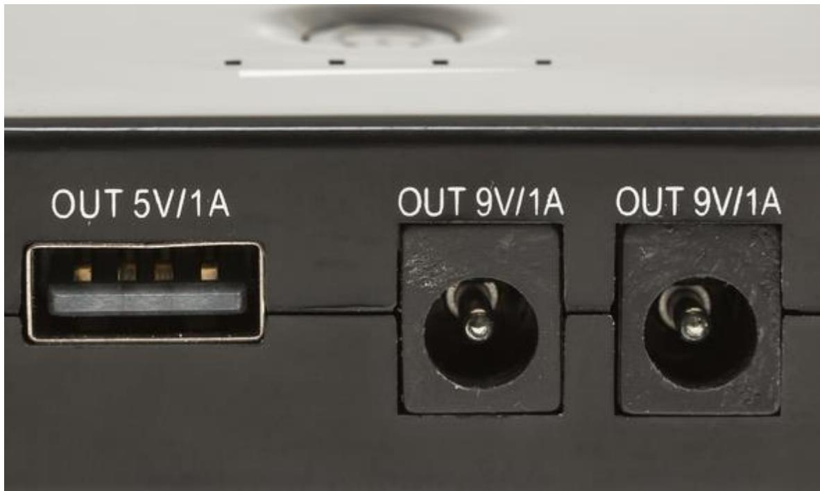
*Zwei stirnseitige Anschlüsse und ein USB-Anschluss können Effekte und sogar ein Mobiltelefon speisen.*
