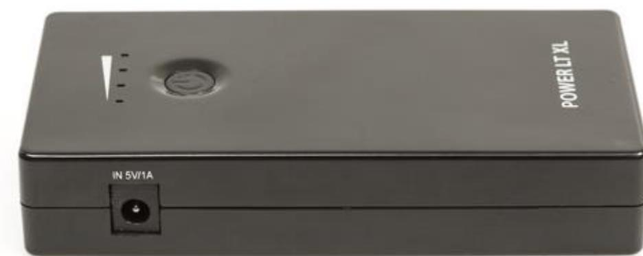
*Über die links angebrachte 5V-Buchse wird das Gerät aufgeladen.*
