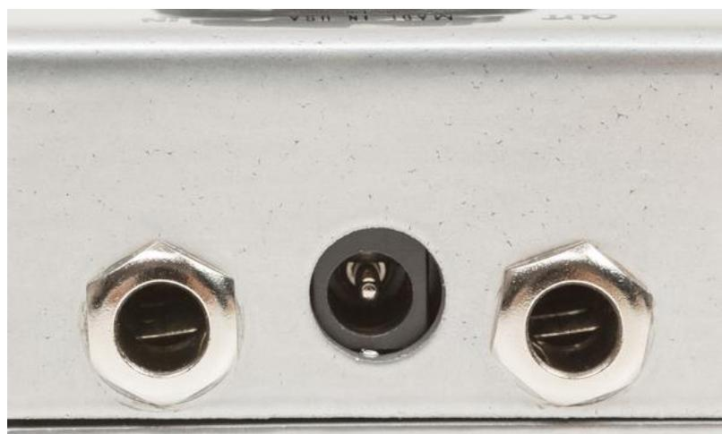
*...die Anschlüsse (von links: In, Netzteil, Out)*
