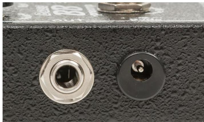
*...sondern auch der Anschluss für den Netzstecker.*
