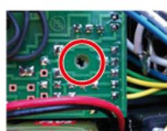
Mit dem internen Trimmer kann der Anteil des Boost in den Mitten eingestellt werden. (Der Trimmer liegt auf der Sub-Platine unter der Hauptplatine)
