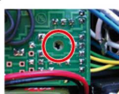
Avec le trim Interne, vous pouvez régler le niveau de boost dans les fréquences médiums. (Le potentiomètre trim se trouve sur un circuit imprimé situé sous le circuit principal)
