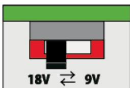
Switch Dip Interne 2 – permet de sélectionner la tension de service : 9 V CC ou 18 V CC.
