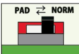
Switch Dip interne 1 ☺ le niveau d'entrée peut être sélectionné pour correspondre dans des circonstances de jeu normales. Le réglage NORM ne devrait pas générer de distorsion non désirée.
