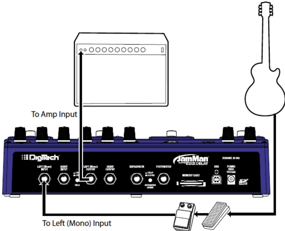
Die Konstellation Mono Amp Input wird wohl die meist gebrauchte Konstellation sein. Die Gitarre wird an den JamMan Delay Looper angeschlossen (Left – Mono Input), und der Left Mono Output (Linker Ausgang) wird an einen Verstärker Eingang angeschlossen. Der Knopf DRY OFF sollte bei dieser Konstellation auf OFF stehen.
