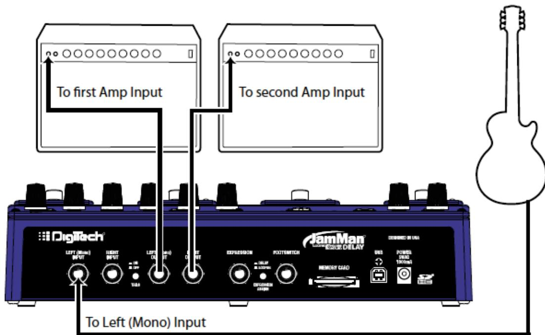
Diese Konstellation bietet ihnen das beste Ergebnis wenn es um breite Stereobilder durch das Ping Pong und Modulations Delay geht. Die Gitarre wird an den JamMan Delay Looper angeschlossen (Left – Mono Input), und der Left Mono Output (Linker Ausgang), als auch der Right Output (rechter Ausgang) werden je an einen Verstärker Eingang angeschlossen. Der Knopf DRY OFF sollte bei dieser Konstellation auf OFF stehen.
