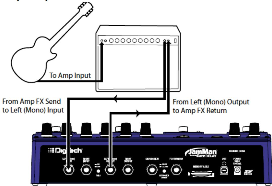
Die Amp Loop Konstellation kann nur dann verwendet werden, wenn ihr Verstärker eine Effektschleife besitzt. Schließen sie die Send Buchse ihres Verstärkers am JamMan Delay Looper LEFT (MONO) Eingang an. Der linke Ausgang des JamMans (LEFT OUT) wird mit dem Effekt Return ihres Verstärkers verbunden.
