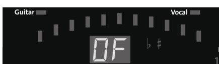
Drücken sie die Setup Taste bis sie „LC“ im Display lesen. Sie haben nun das Menü Low-cut Filter aufgerufen. Sie können nun entscheiden, ob sie die Frequenzen unterhalb von 75Hz abschneiden oder zulassen. Nach einem Augenblick erlöscht „LC“ im Display und sie können mittels der +/- Tasten zwischen on und off hin und herschalten.
